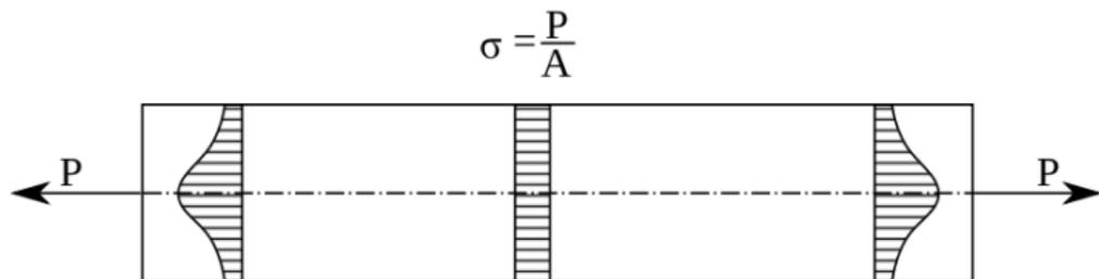
Esquema de las tensiones longitudinales en un prisma solicitado por fuerzas puntuales. Cerca de los extremos la distribución no es uniforme, pero hacia el centro de la sección los esfuerzos tienden a ser exactamente iguales a los que se habrían obtenido bajo cargas uniformemente distribuidas, y estáticamente equivalentes a las cargas puntuales.
