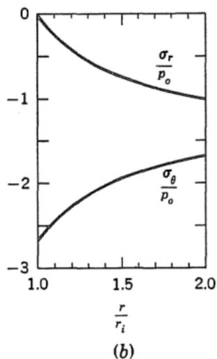
Distribución de la tensión radial  $\sigma_r(r)$  y la tensión tangencial  $\sigma_\theta(r)$  en un cilindro con  $r_o = 2r_i$  debido (a) presión interna  $p_i$  y (b) presión externa  $p_o$ .
