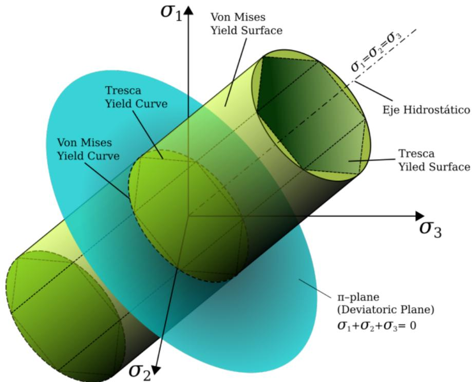
Las superficies de fluencia de von Mises en coordenadas de tensión principales circunscriben un cilindro con radio  $\sqrt{\frac{2}{3}}\sigma_Y$  alrededor del eje hidrostático. También se muestra la superficie de rendimiento hexagonal de Tresca.
