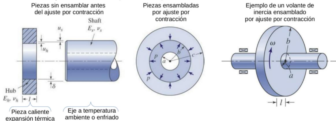
El método de ajuste por contracción se utiliza para ajustar engranajes, poleas, mangas y otros componentes en ejes sólidos y huecos, pero la aplicación más popular es encajar rodamientos en ejes.
