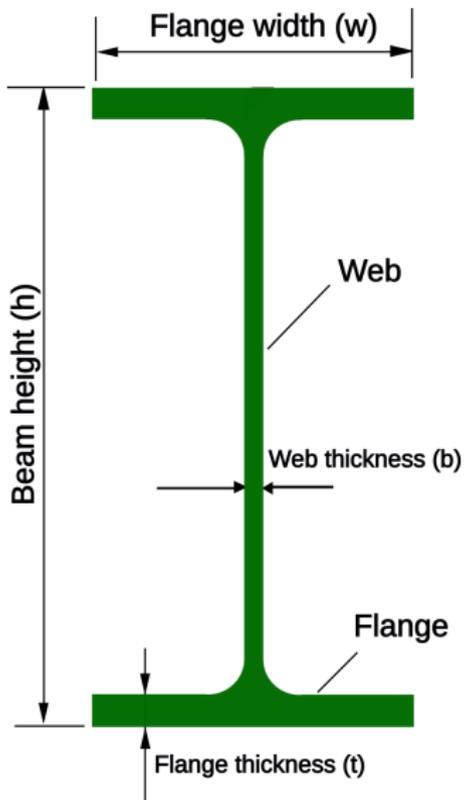
Las Vigas IPS y las Vigas IPR se disponen horizontalmente con el objetivo de vincular columnas entre ellas. se encargan de soportar las cargas de las losas o los elementos planos colocados sobre ellas además de llevar dichas cargas hacia las columnas, de ésta hacia sus bases y de éstas hacia el suelo.
